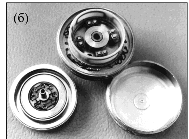
Рис.2.3. Кинематическая схема, системы координат (а) и элементы конструкции (б) роторного вибрационного ДНГ: 1 – ротор; 2 – вал двигателя; 3 – двигатель; 4 – упругие торсионы
